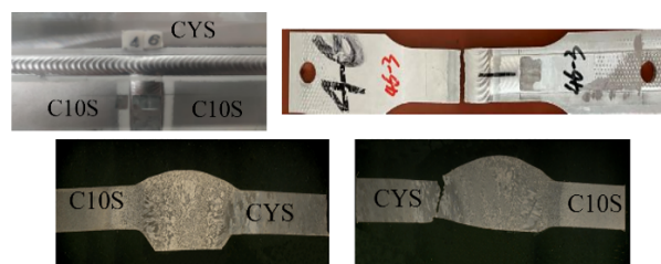
图7 T字接头焊缝及断口横截面宏观形貌
